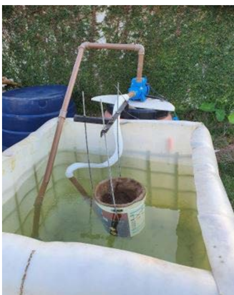
Figura 3 - Estrutura fixada (bomba + balde + malha)
