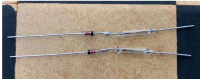
Figura 8 - Solda incorreta do diodo.
