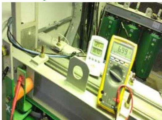
Foto 37 - Aplicação de tensão 220 V no primário e medição no secundário X-7 Vca.
