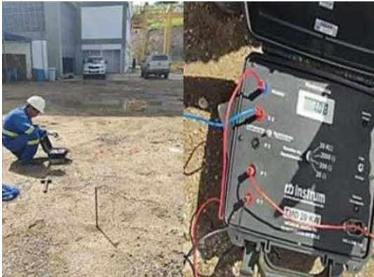
Foto 29 - Realizando medição da resistividade do solo.
