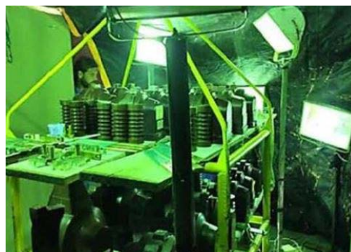
Foto 14 - Implantado estufa com lâmpadas, para auxiliar na secagem dos equipamentos.
