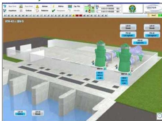
Foto 43 - Supervisório com as duas bombas em funcionamento, indicando a normalização da EBV-5, devolvendo a plena condição de funcionamento as bombas e demais sistemas.
