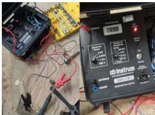
Foto 21 - Verificando das condições elétricas dos cabos de média tensão
