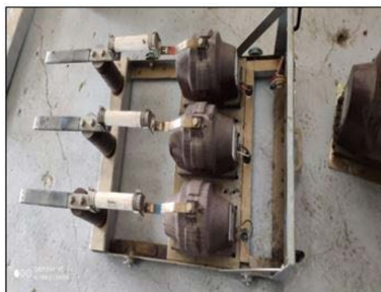
Foto 6 - Peças sendo aquecidas na estufa, para remoção da umidade.
