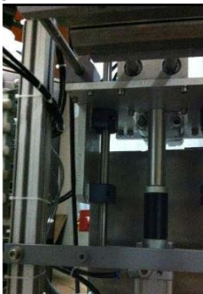
Figura 44 – Tracionamento do filme.
