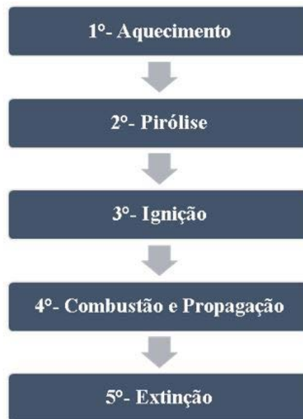
Figura 18 – Processo de combustão do polímero
