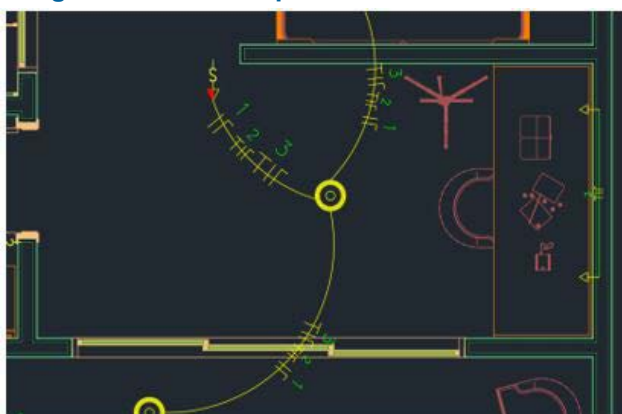
Figura 11 - Tomada posicionada em vão aberto
