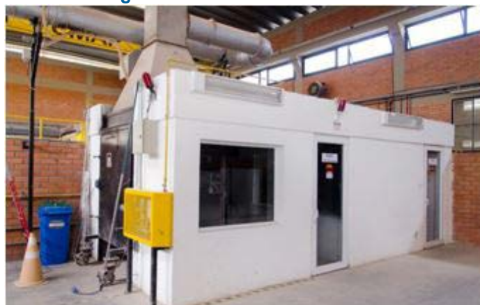
Figura 23 – Ensaio de canto SBI
