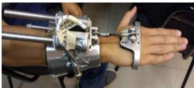
Figura 1 - Órtese ativa para supressão do tremor Parkinsoniano desenvolvida pelo NIATS.
