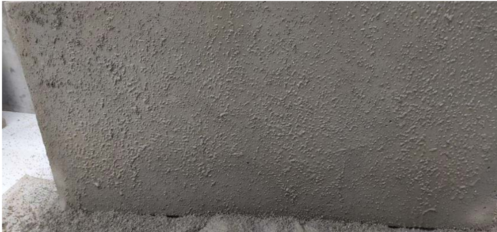
Figura 3 – Placa de concreto com chapisco utilizando a areia IPT 1,2 MM.
