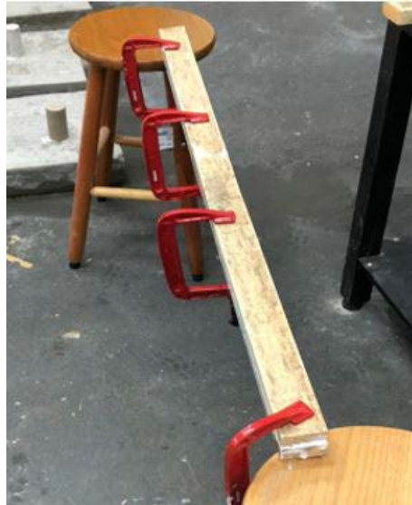
Figura 1- Viga laminada colada.
