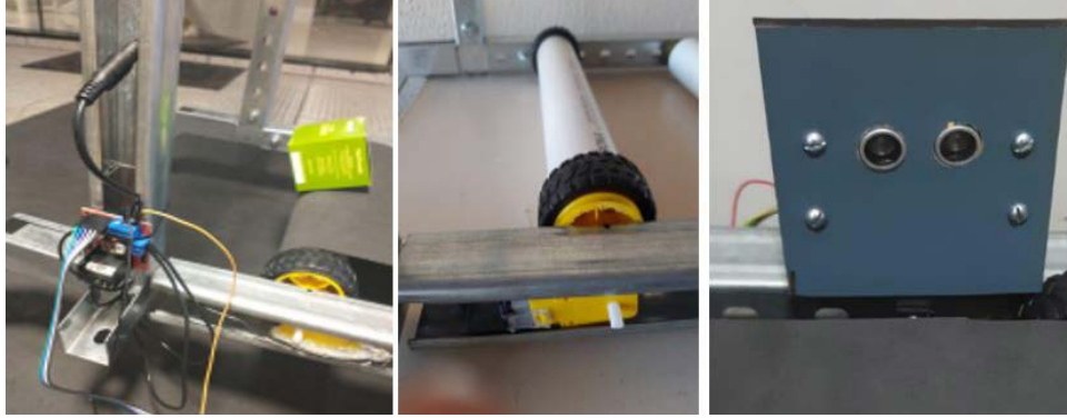
Figura 8, 9 e 10 - Componentes da estrutura de automação. A esquerda o driver de acionamento dos motores, no centro, os motores e na direita, o sensor ultrassônico.
