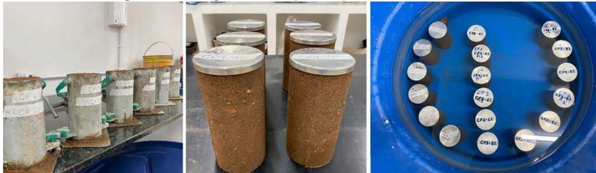
Figura 7- Moldagem dos corpos de prova e cura úmida
