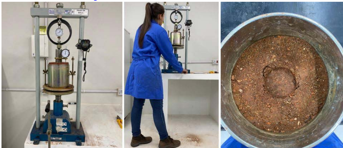
Figura 6 - Desenvolvimento do ensaio de CBR
