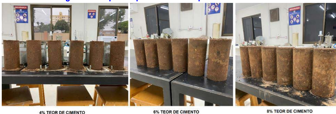
Figura 3 - Corpos de prova moldados para o ensaio de RCS
