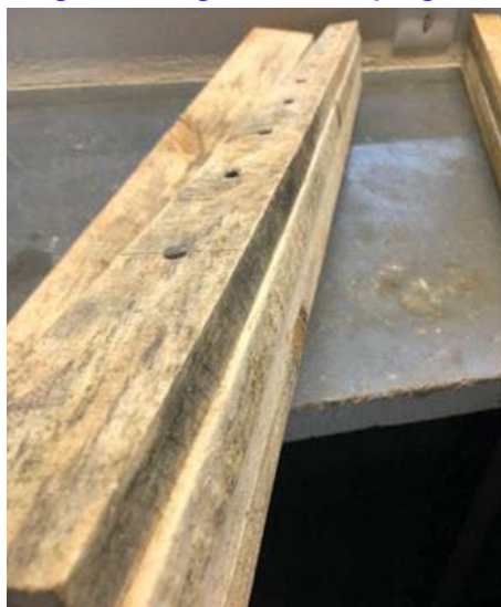
Figura 2 - Viga laminada pregada.
