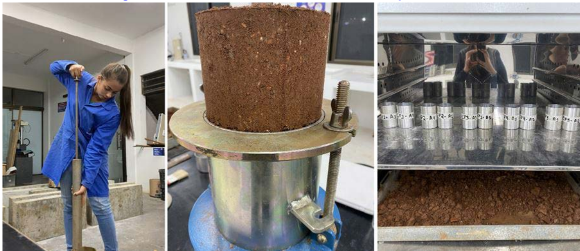
Figura 4 - desenvolvimento do ensaio de compactação
