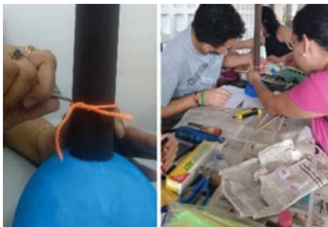
Figura 15 - Processo de furar o cilindro com o auxílio da lã para marcar.
