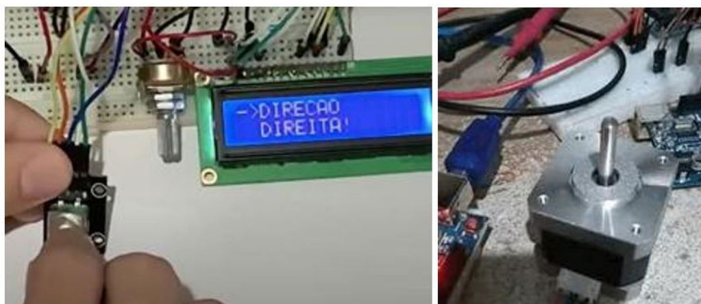
Figura 5 – Testes iniciais realizados na protoboard para (a) teste do menu, (b) acionamento do motor
