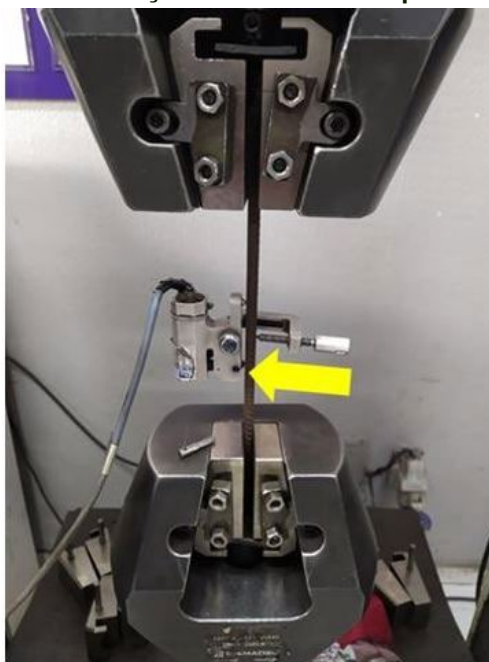
Figura 5 – Ensaio de tração utilizando a máquina Shimadzu AGX
