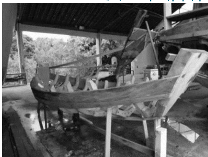
Figura - Estrutura inicial de uma embarcação, com a proa, popa, quilha e cavernas.
