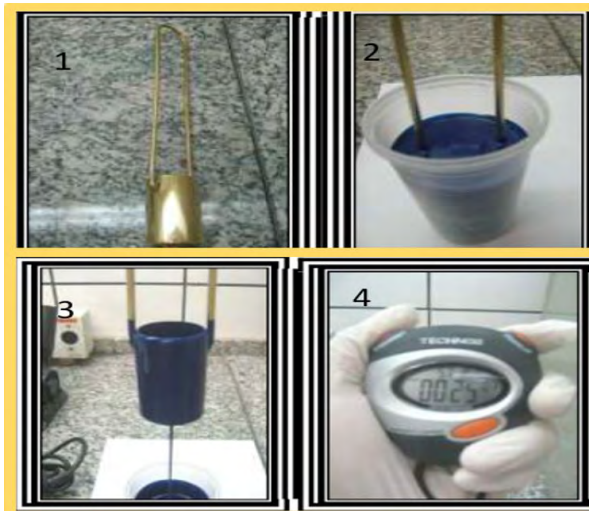
Figura 5 - Metodologia da medição de viscosidade.
