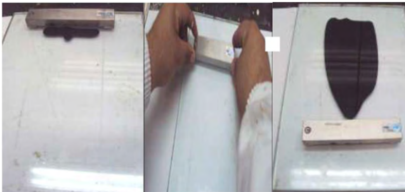
Figura 6 - Representação do processo para medição da secagem.
