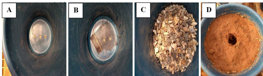
Figura 4 – Recipientes de plástico com capacidade para 4L (A) perfurados em sua base inferior, posteriormente (B) colocado uma tela de náilon, (C) preenchido com brita a fim de evitar a passagem de sedimentos e (D) preenchidos com solo devidamente peneirado.
